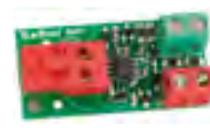
Interfaz BUS XIB (Si la tarjeta E024S o E045S se utiliza con fotocélula no Bus)
