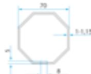
TM2 45 adaptador para tubo octogonal 70 mm
